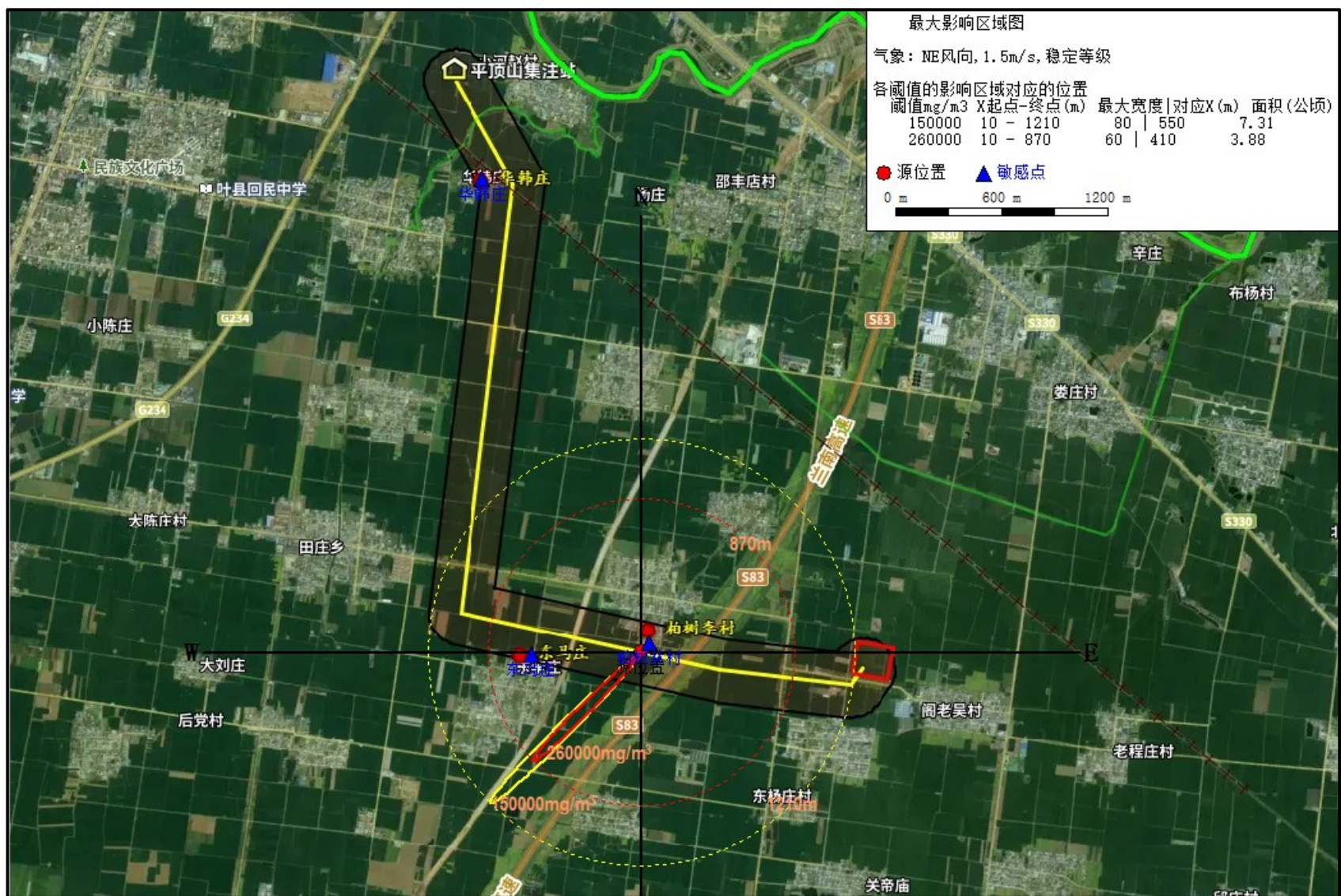
图 8.7.1-2 本项目管线泄漏事故产生的CH 4 预测浓度达到关注限值最大影响范围图（最不利）
